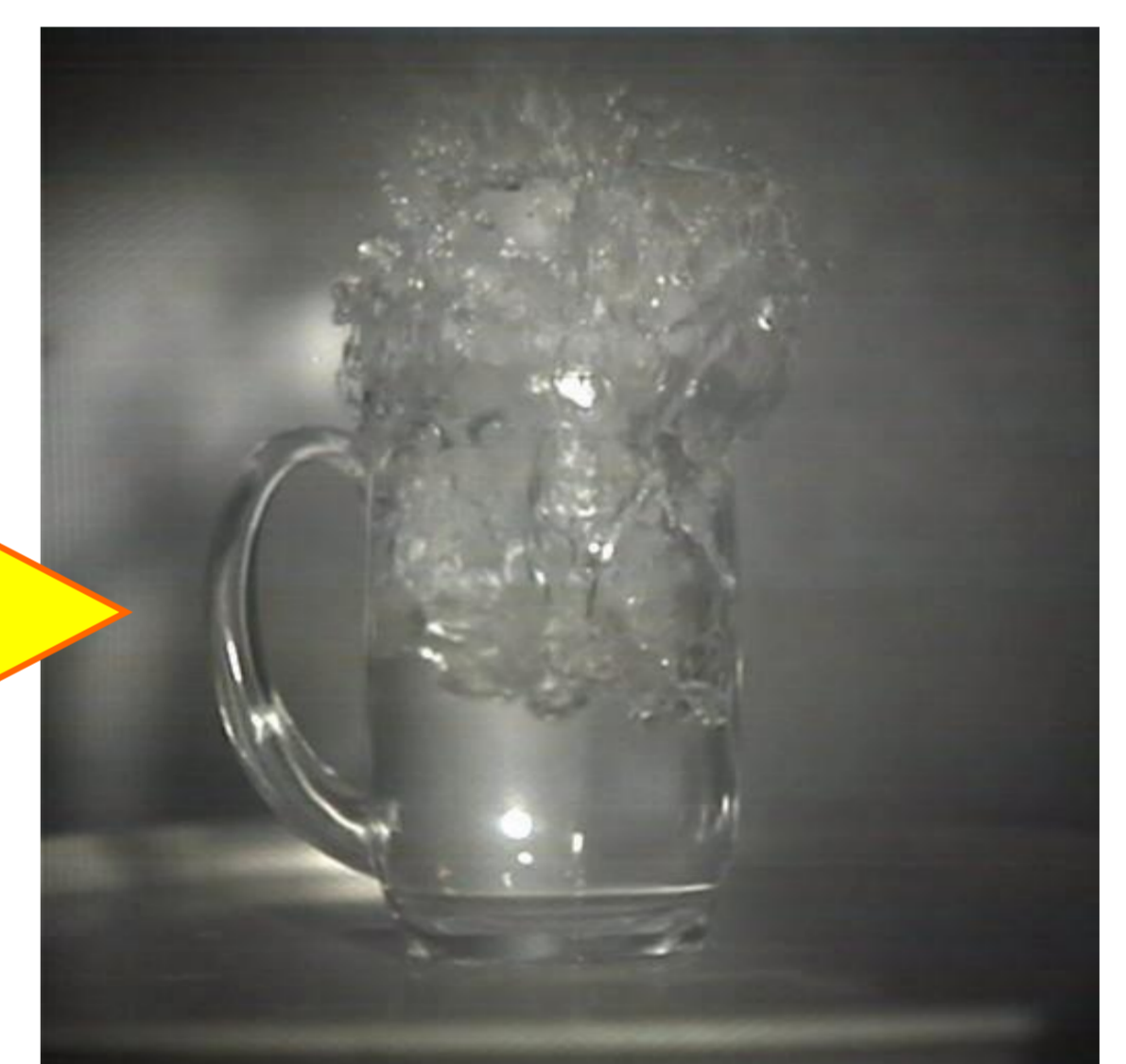
蒸気の泡が表面に達した瞬間に破裂、周辺に激しく飛散
