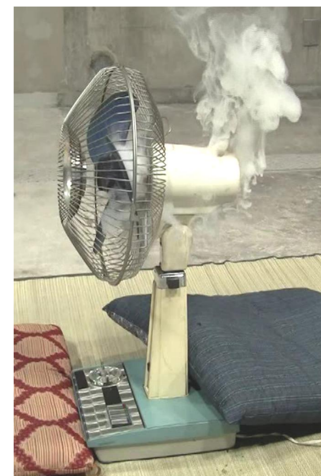
コンデンサーから発煙しました(写真左)。炎で溶けた樹脂が座布団に落ちて着火しました(写真右)
