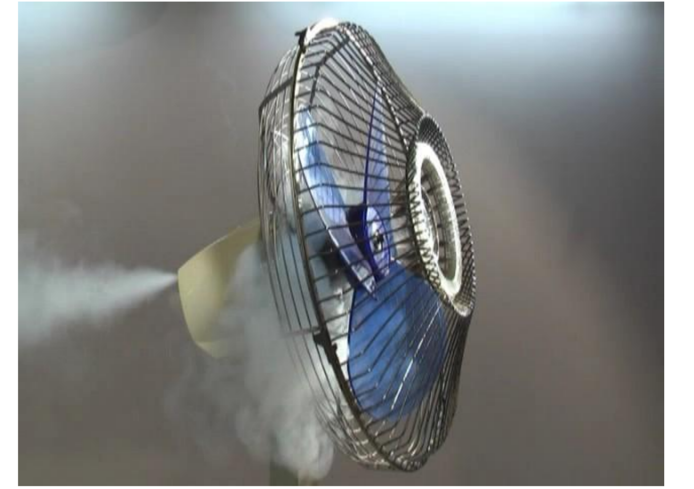
コンデンサーから可燃ガスが吹き出しています
