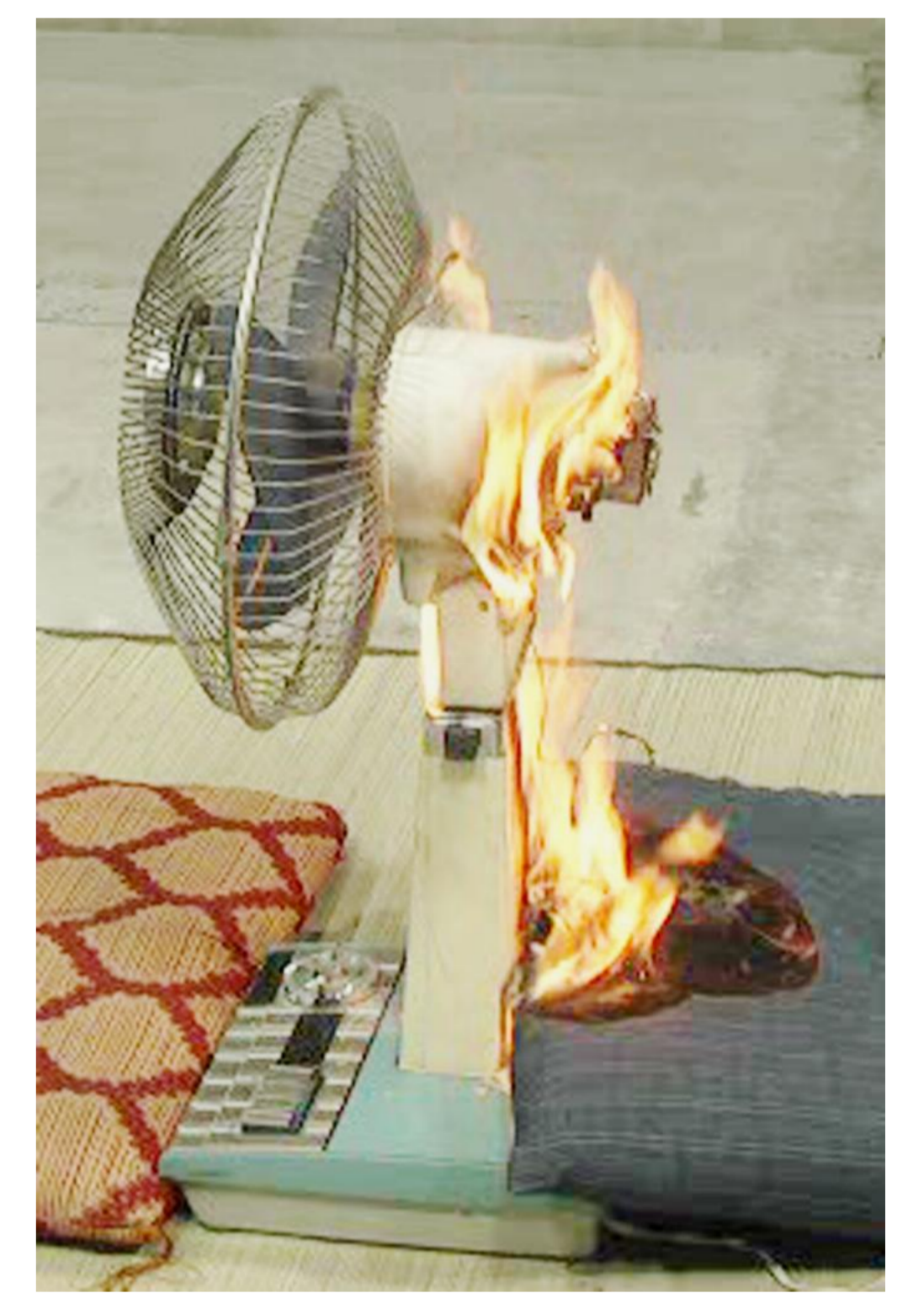
コンデンサーから発煙しました(写真左)。炎で溶けた樹脂が座布団に落ちて着火しました(写真右)
