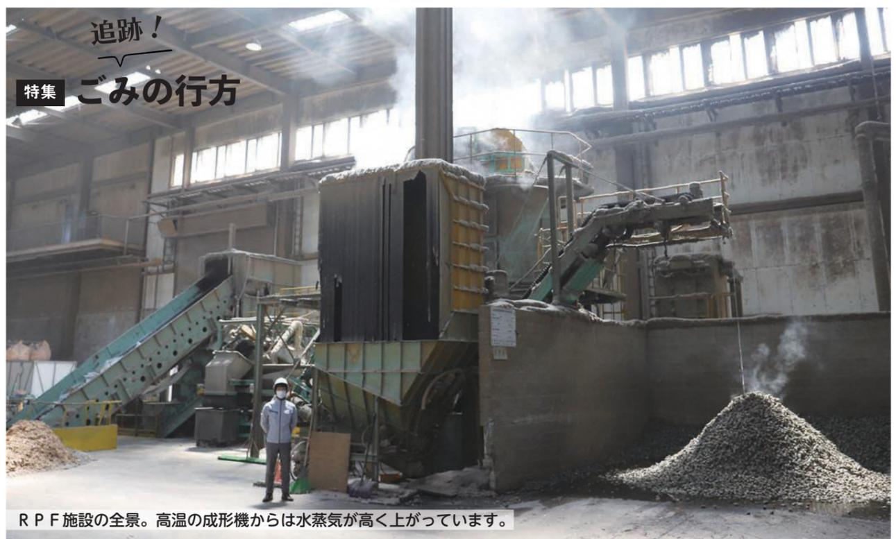
RPF施設の全景。高温の成形機からは水蒸気が高く上がっています。
