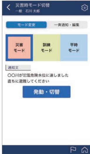
緊急時でも操作に迷うことがないようにシンプルなボタン設計と容易な操作で「災害モード」を発動できます。通知文で状況伝達や避難指示もあわせて行えます。
