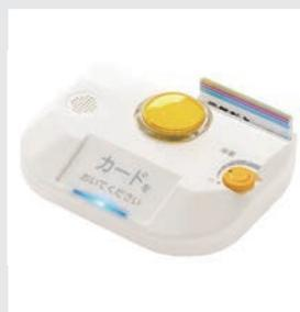
移動体通信網を利用するシンプルな装置。利用者がカードで発信した内容が「結ネット」を通じて必要な人に一斉通知。入力文字から音声に変換し、利用者にメッセージも返信できます。
